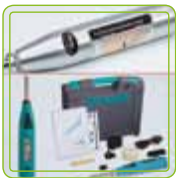
Resistência do betão "In Situ" - Esclerómetro
