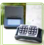
Deteção de vazios nas estruturas - Pundit
