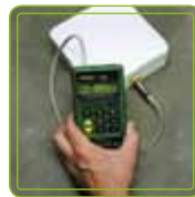
Humidades em rebocos / madeiras
